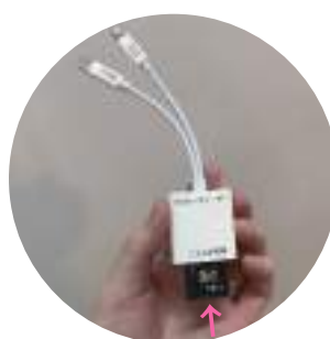
⑥取り出した SD カードをリーダーに差し込みます
