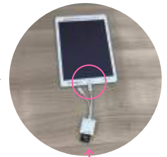
④SD カードをリーダーに差し込み、iPad に接続します
